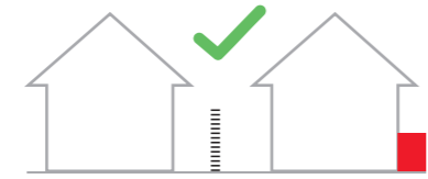
Groupe extérieur correctement placé
